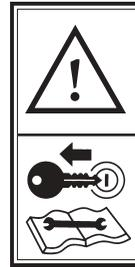
Pare el motor del tractor y evite que se arranque durante los trabajos de mantenimiento o reparación.
