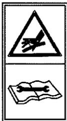
Posibilidad de penetración de fluido hidráulico a presión. Mantenga en buen estado las conducciones.
