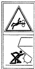
Peligro de lesiones graves por choque o aplastamiento con los discos y palas lanzadoras.
