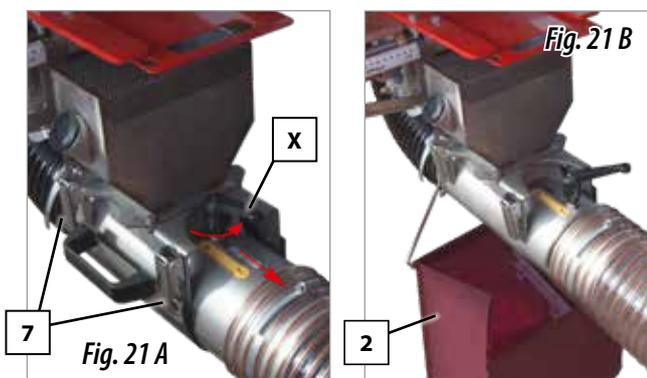
Girar la maneta para liberarla (X, Fig. 21 A) y desplazarla hasta la posición "NO" (posición de ensayo).
