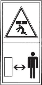
Danger d'écrasement si on travaille dessous la machine, on doit l'assurer pour éviter son écroulement. Danger de graves lesiones.
