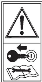
Pare el motor del tractor y evite que se arranque durante los trabajos de mantenimiento o reparación de la abonadora.
