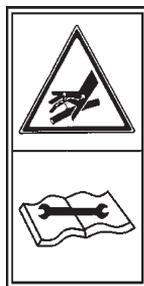
Posibilidad de penetración de fluido hidráulico a presión. Mantenga en buen estado las conducciones. **Peligro de lesiones graves.**
