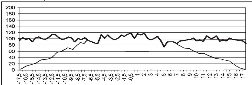
La regularidad en la distribución se mide mediante el coeficiente de regularidad o de variación (C.V.). El C.V. se obtiene mediante una fórmula estadística una vez solapados los diagramas. Según acuerdo de los fabricantes de abonos, el C.V. es muy bueno si está por debajo del 10%. Es regular si está entre el 10 y el 15% y es malo -a evitar- si está por encima del 15%.
