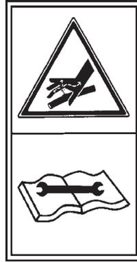
Peligro de lesiones graves por penetración de fluido hidráulico a presión. Mantenga en buen estado las conducciones hidráulicas.
