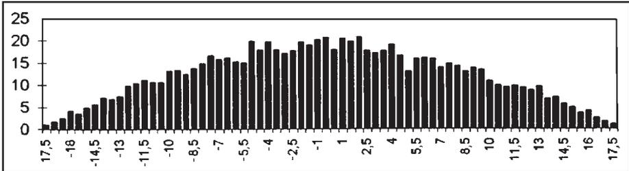
Para obtener una distribución uniforme deberemos realizar una serie de solapamientos para que el resultado final sea un diagrama de distribución plano como el de la figura (en este caso, resultante de realizar solapamientos con pasadas a 24 metros del diagrama anterior).
