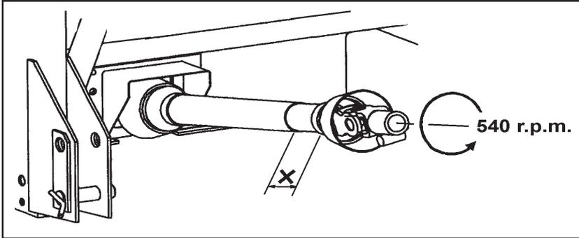
Comprobar que los extremos de los ejes telescópicos de la transmisión no se toquen al levantar la abonadora de su posición de trabajo (x).
