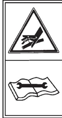
Peligro de lesiones graves por penetración de fluido hidráulico. Mantenga en buen estado las conducciones.
