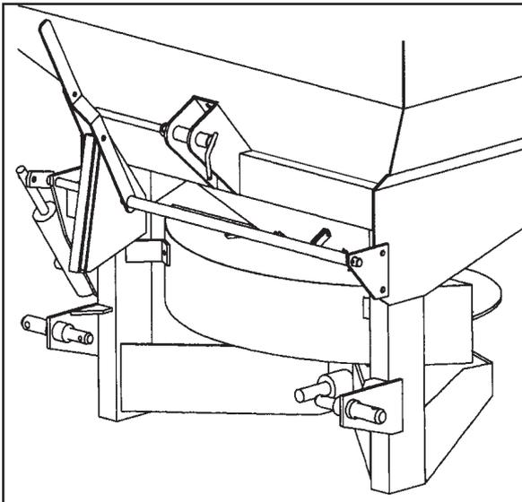
Para trabajar, abrir la válvula de cierre de manera que el cilindro hidráulico actúe sobre las palancas. Situar la válvula de cierre en un lugar accesible desde el interior del tractor.
