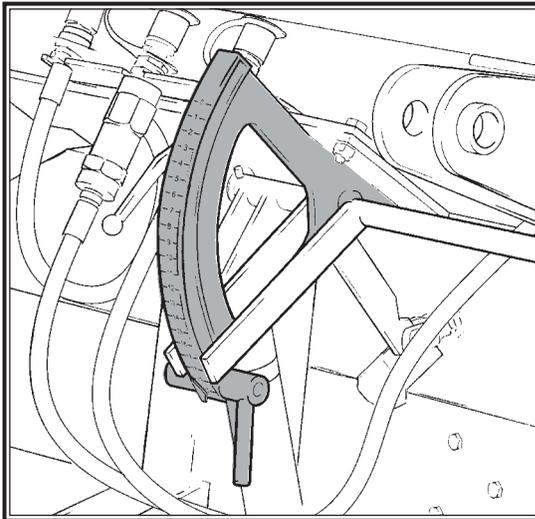
Ponga la abonadora en funcionamiento a 540 r.p.m. y abra la salida durante un minuto (tenga en cuenta de forma orientativa las dosis que figuran en las tablas ya que en un minuto en la posición nº12 saldrán 50 Kg. aproximadamente de abonos con peso esp. en torno a 1 Kg./litro).
