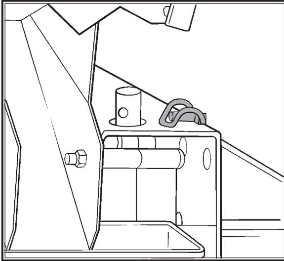
Coloque el indicador de la posición de la boquilla en el nº7 y sitúe el canal para pruebas de caudal como se indica en la figura superior.
