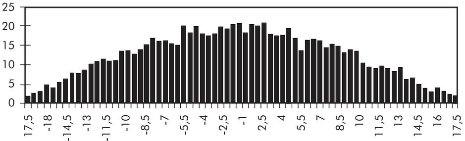
Para obtener una uniformidad en la distribución repartiremos el abono solapando las pasadas de manera que el resultado final sea un diagrama plano como el de la figura:
