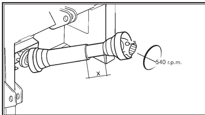
Comprobar que los extremos del eje telescópico de la toma de fuerza (X, fig.) no se toquen al levantar la abonadora hasta su posición de trabajo. Cortar dichos extremos, si fuera necesario, dejando juego suficiente para que, con la toma extendida al máximo, quede conectada unos 15 cm.
