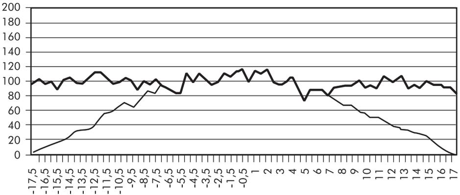
La regularidad en la distribución se mide mediante el coeficiente de variación (CV). El CV se calcula mediante una fórmula estadística a partir de los datos obtenidos del solapamiento. Según acuerdo entre los fabricantes de abonos, el CV es muy bueno si está por debajo del 10%, regular si está entre el 10% y el 15% y malo a evitar si está por encima del 15%.
