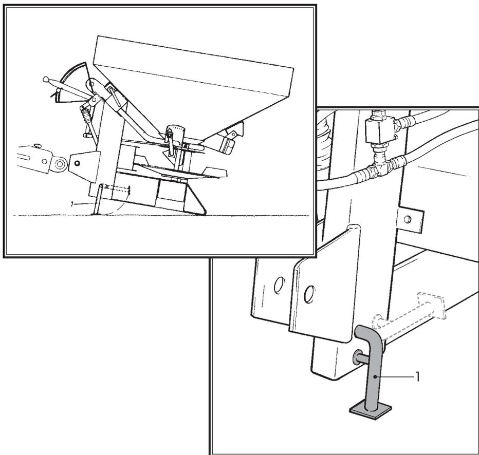
En posición de trabajo la abonadora debe quedar horizontal y con el disco a 75 cm del suelo, ver figura.
