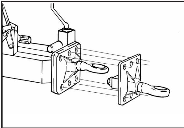
Una vez enganchada al tractor, la abonadora debe quedar horizontal. Para facilitararlo, la anilla del enganche permite dos alturas diferentes.
