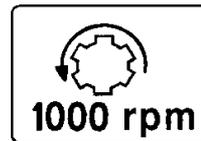
Sentido de giro y velocidad de la toma de fuerza (sólo en máquinas con turbina de accionamiento mecánico)
