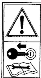
Paré el motor del tractor y evite que se arranque durante los trabajos de mantenimiento o reparación de la sembradora.
