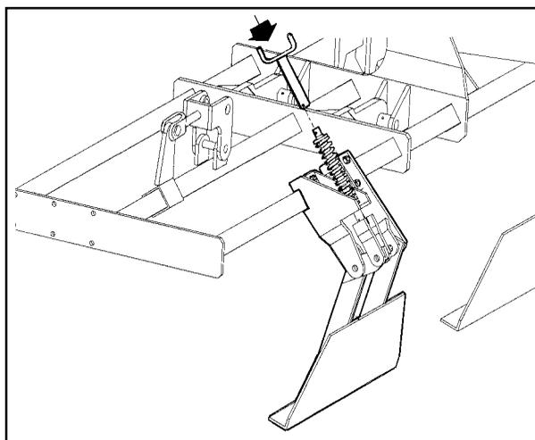
El nivelador deberá arrastrar tierra sin que ésta sobresalga por encima de la chapa. Para borrar las rodadas de la propia sembradora hay unos brazos borrahuellas que deberán regularse en altura.
