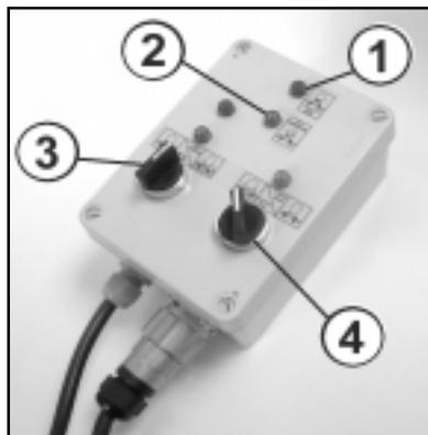
3. Conmutador de apertura y cierre de las salidas de las partes plegables. A la derecha tiene todas las salidas abiertas. A la izquierda cierra las salidas del plegado y sólo deja abiertas las de la parte central. En la posición intermedia queda en reposo y guarda la última posición aunque se desconecte el equipo.
