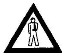
Al realizar las pruebas de dosificación de semilla o cuando la máquina está trabajando, evite introducir las manos u otros objetos en el interior de la tolva en la zona del agitador, ya que pueden producirse accidentes o averías al impedir el trabajo normal de este mecanismo.
